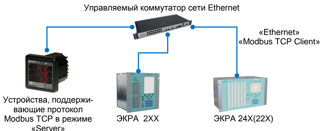
Рисунок 5 – Применение терминала в качестве концентратора данных в сети Ethernet
